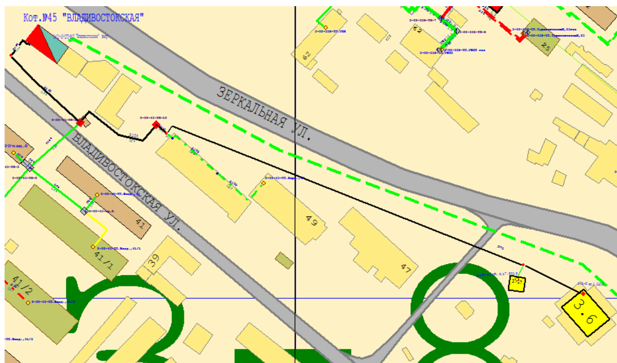
Рисунок 3.103. – Результат гидравлического расчета - расчетный путь теплоносителя от Котельной №45 - "Владивостокская" до 3-02-45.ПП.3.6.2015.
