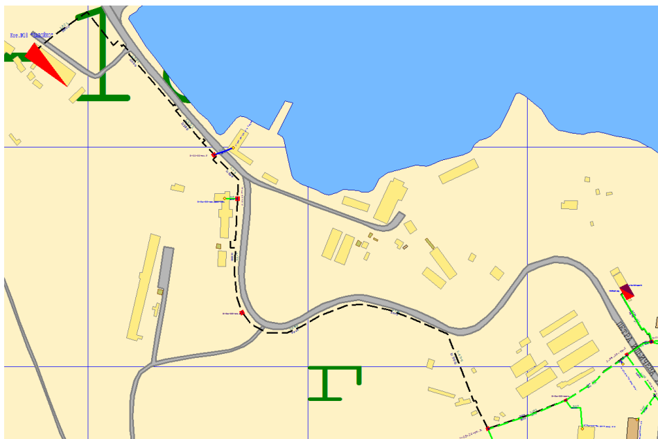
Рисунок 3.79. – Результат гидравлического расчета - расчетный путь теплоносителя от Котельной №18 - "Завойко" до 2-05-20-ЦТП-3
